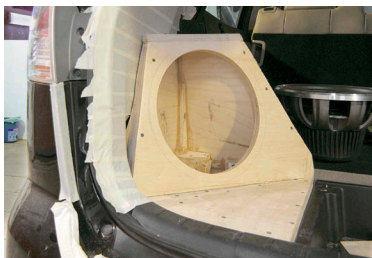
Древняя восточная мудрость: одна цифровая фотография заменит тысячу вордовских знаков — конструкция сабвуферного корпуса
