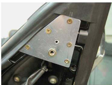
Усиление крепёжного узла в уголке двери
