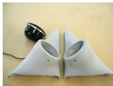
Фиксация пищалок — потайными стопорными винтами
