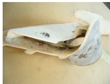
Опорное кольцо СЧ-головки интегрировано в стойку
