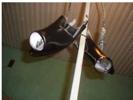
Уголки зеркал перед установкой пищалок
