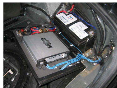
В откинутом положении открывается доступ ко второму усилителю и аккумулятору
