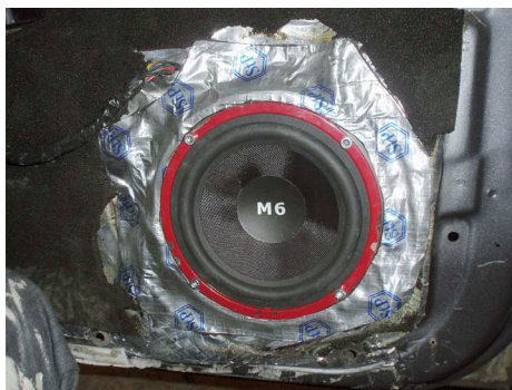
Мидбас на своём месте, с полной виброизоляцией
