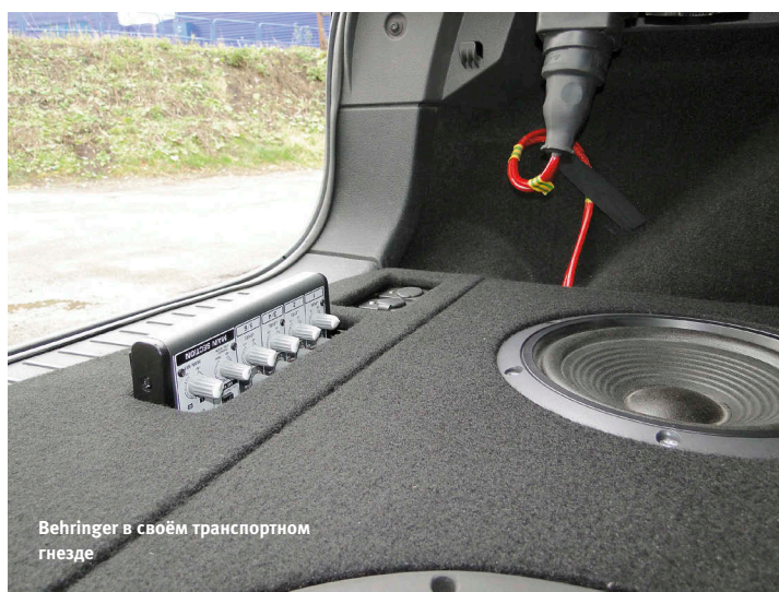
Акустический блок разделён на три объёма, самый большой (под сабвуфер) уходит в диск запасного колеса
