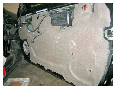
И наконец, на место возвра- щается штатная звукоизоляция
