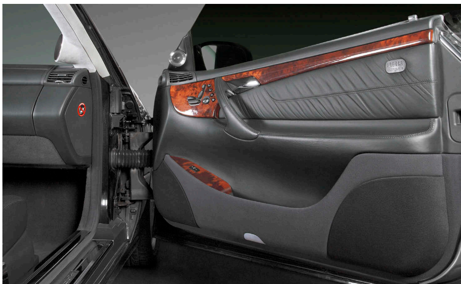
Акустика на дальнем конце двери — настоящая, на ближнем — бутафорская, для сохранения стиля
