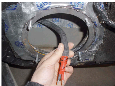
Подготовка посадочного места и проводки мидбаса
